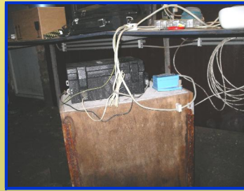
FIGUUR 2: Pilaar met de seismometer (blauw) en de accelerometer (zwarte kist) in het station van La Chartreuse (LCH) in Luik.
